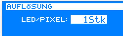
Im AUFLÖSUNG-Menü kann angegeben werden, aus wievielen LEDs ein Pixel besteht. Es können Werte zwischen 1 und 100 eingestellt werden.
