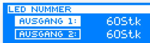
Der Controller hat zwei Datenausgänge um die Digital Strips zu steuern. In diesem Menü bestimmen Sie wieviele LEDs an den jeweiligen Ausgang angeschlossen sind bzw. angesteuert werden sollen.
