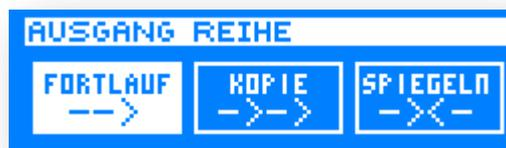
Im AUSGANG REIHE-Menü wird eingestellt, wie das Zusammenspiel zwischen den beiden Digitalausgängen abläuft.
