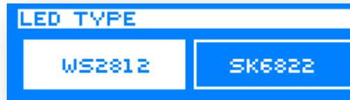
Mit den AUFWÄRTS/ABWÄRTS-Tasten können Sie den richtigen LED-Typ auswählen. Mit der ENTER-Taste wird die hervorgehobene Auswahl gespeichert und das Menü verlassen.
