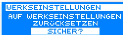
In diesem Menü kann der Controller auf Werkseinstellungen zurückgesetzt werden.
